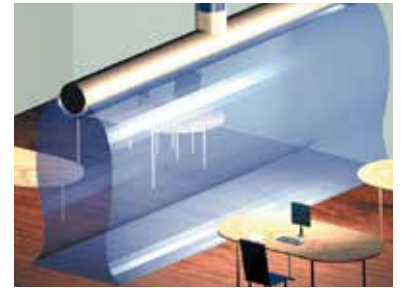
Typisches Strömungsverhalten für einen Standard-Quellauslass mit \Delta T Zuluft von -3^\circ\text{K}
